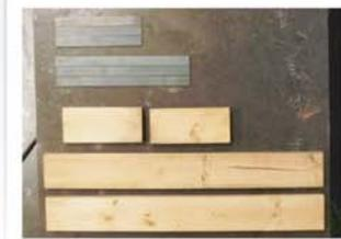
30mmLアングル(3mm厚)と木材(1×4材)、25mmフラットバー(3mm厚)をカットして材料をそろえる
