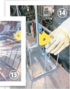
土台のアングルと鉄筋を溶接する
