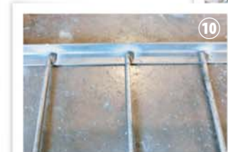
残りの丸棒も全て溶接し、土台部分が完成(写真⑨⑩)。
