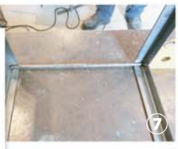
アングルの枠を丸棒で繋げていく。先に角の4本を溶接する(写真⑦⑧)。
