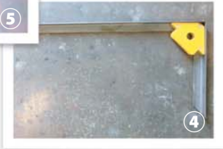
アングル同士を直角に組んで、400mm×200mmの枠を2つ作る(写真④⑤⑥)。
