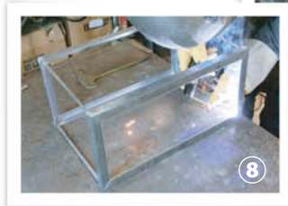
アングルの枠を丸棒で繋げていく。先に角の4本を溶接する(写真⑦⑧)。
