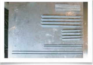
10mmφ異形鉄筋、6mmφ丸棒、20mmLアングル(3mm厚)をカットして材料をそろえる
